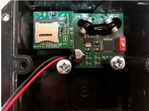
Kartenhalter öffnen, indem man das metallische Blech nach **oben** schiebt und den Deckel aufklappt. Die Karte mit der schrägen Seite nach unten rechts einlegt und dann wieder durch verschieben arretiert. Dabei nicht mit Gewalt arbeiten!!! Ein Kuli oder kleiner Schraubenzieher kann das Einlegen erleichtern!
