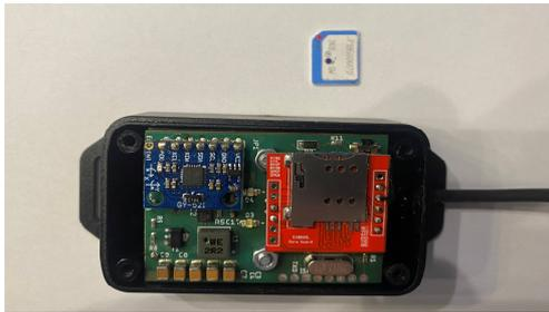
Danach bitte den Melder aufschrauben und die SIM Karte mit der flachen Seite und Kontakten nach unten, in den Kartenhalter einführen! Einschieben bis die Karte hörbar einrastet und beim Loslassen arretiert ist! Bitte keine Gewalt anwenden !!!
